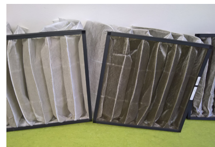
Pro srovnání se můžete podívat na použité filtry, z nichž jeden odvádí vzduch z kanceláří pryč a druhý přivádí vzduch do kancelářské budovy. (Zdroj: Archiv Nadace Partnerství)
